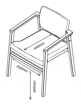
1CGD1-300 800H | 500W | 555D (mm) Weight: 8.5kg
